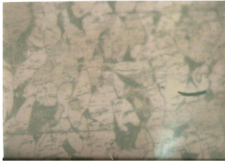
Gambar 19: Daerah HAZ Spesimen dengan arus 100 A dan kecepatan 0,25 cm/dtk
