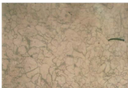
Gambar 14: Daerah HAZ Spesimen dengan arus 100 A dan kecepatan 0,13 cm/dtk
