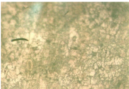
Gambar 20: Daerah HAZ Spesimen dengan arus 100 A dan kecepatan 0,25 cm/dtk
