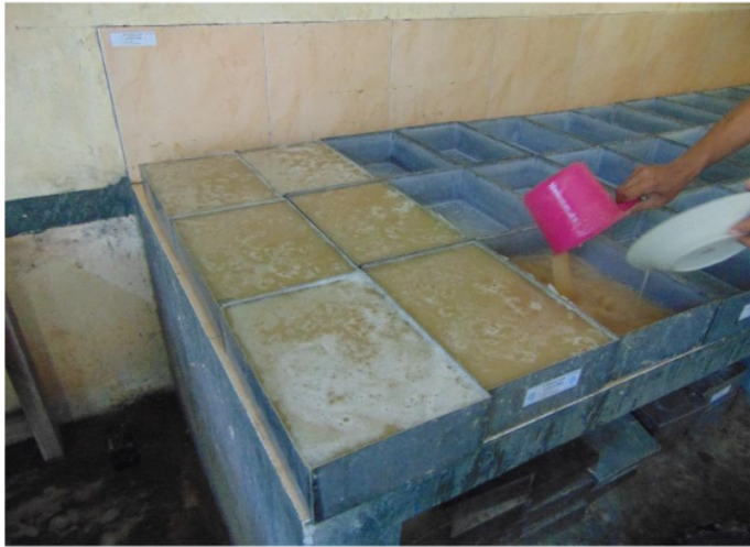
Gambar 72. Pencetakan dan pengentalan larutan karagenan
