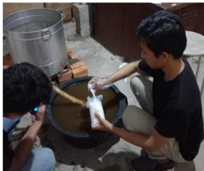
Gambar 58. Pencampuran KOH dengan cairan agar
