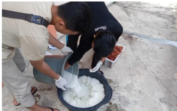
Gambar 51. Pembuatan larutan kapur tohor
