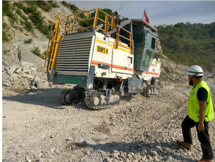
Gambar 6.3 Pembongkaran Batu Kapur dengan Surface Miner
