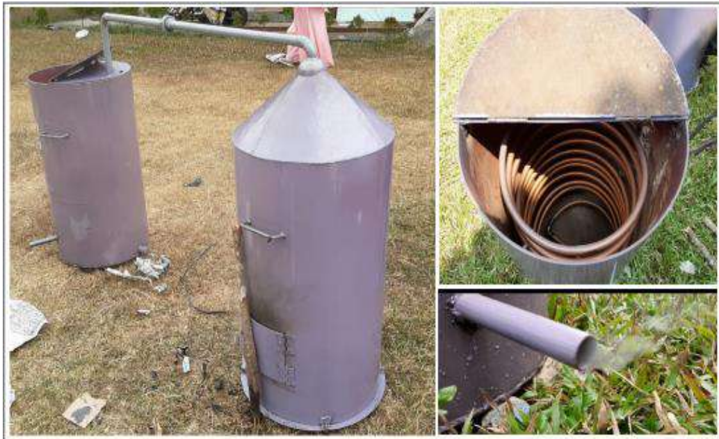
Gambar 4.1 Rangkaian alat pirolisis kayu karet menjadi asap cair
