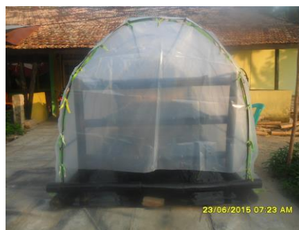
Gambar 1. Profil alat pengering yang dibuat tampak depan dan ruang bagian dalam
