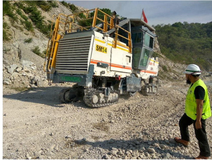
Gambar 6.3 Pembongkaran Batu Kapur dengan Surface Miner
