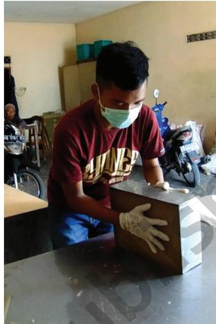
Gambar 5.26 Posisi saat akan mengeluarkan agar dari cetakan
