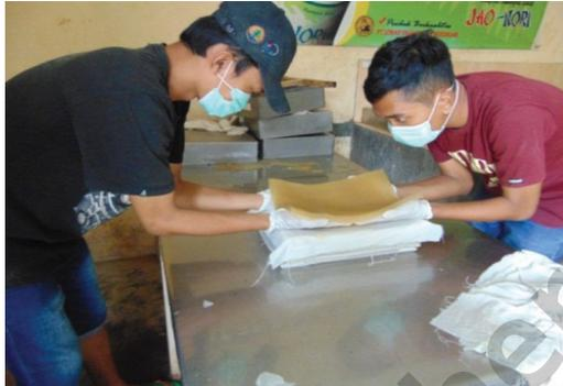
Gambar 5.33 Penyusunan agar-agar
