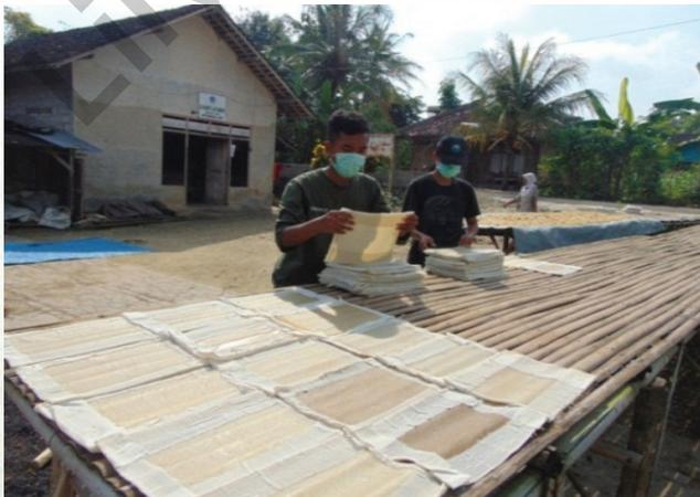
Gambar 5.42 Penyusunan agar pada tirisan/jemuran
