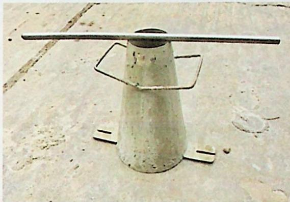
Gambar 3.12. Alat uji *slump flow*
