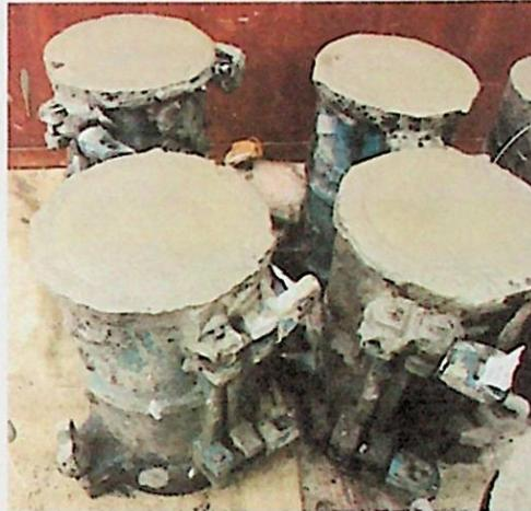
Gambar 3.22. Proses pencetakan beton
