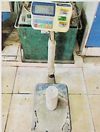
Gambar 3.24. Proses pengujian berat jenis beton
