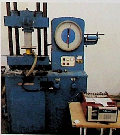
Gambar 3.25. Proses pengujian kuat tekan beton
