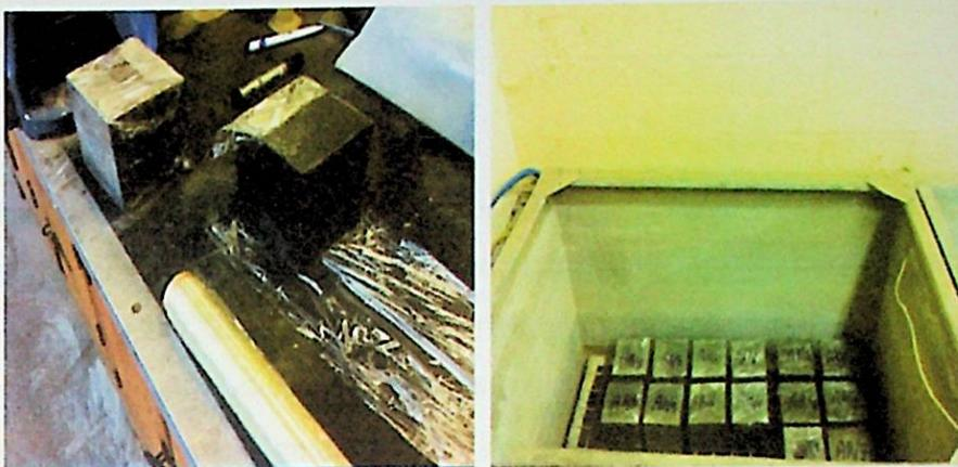
Gambar 2.8. Metode perawatan dengan membran (Hilal et al, 2014)
