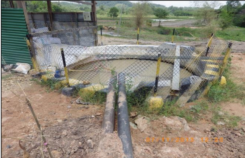
Gambar 37. Penambahan Kapur pada Air Asam Tambang KPL Udongan
