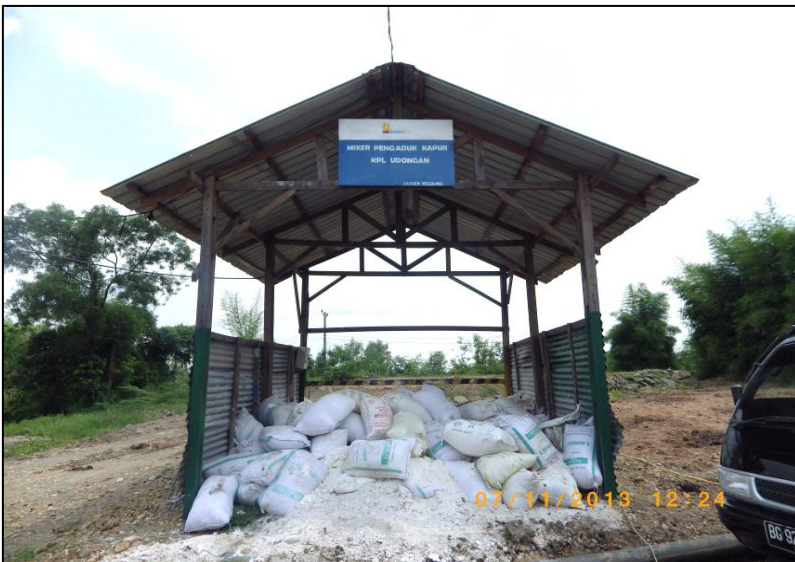
Gambar 35. Kapur penetralisir Air Asam Tambang di KPL Udongan PTBA
