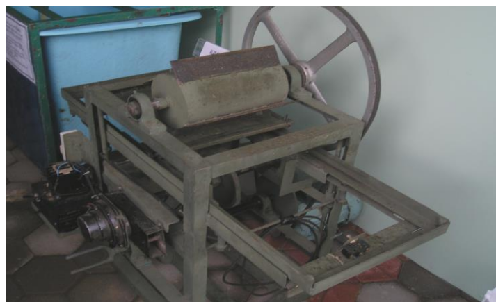
Gambar 11. Alat penyerut daun Nenas sebelum dimodifikasi
