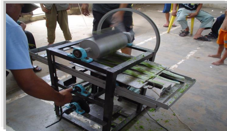
Gambar 11. Alat penyerut daun Nenas sebelum dimodifikasi
