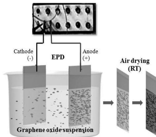
Gambar 3. Elektrodeposisi Karbon
