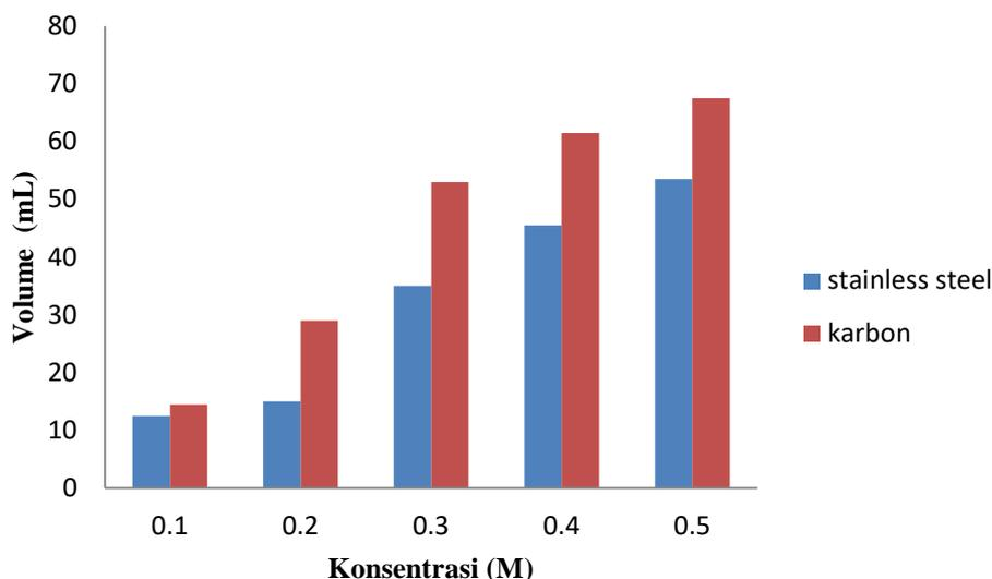
Gambar 4.6 Grafik Pengaruh elektroda Terhadap Volume Gas Hasil Elektrolisis pada Tegangan 6 volt dan berbagai Variasi Konsentrasi  $H_2SO_4$
