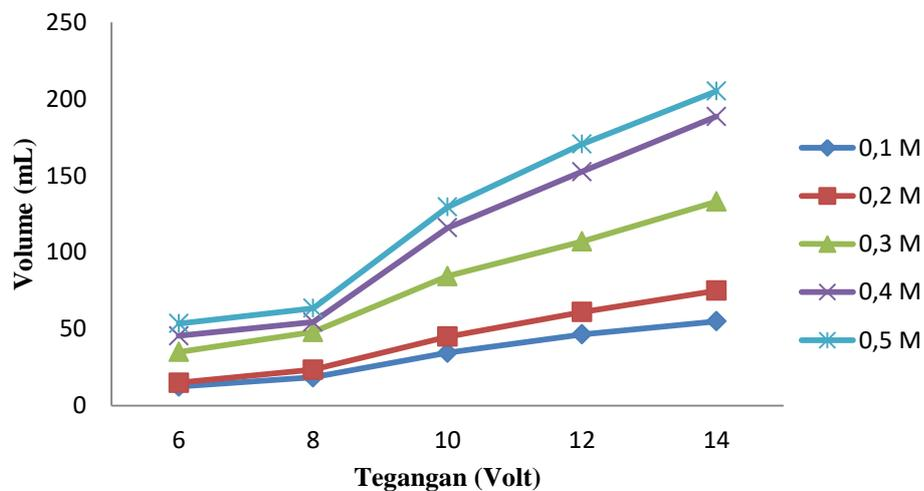
Gambar 4.1 Grafik Pengaruh Tegangan terhadap Volume Gas Hasil Elektrolisis dengan elektroda stainless steel pada berbagai variasi konsentrasi  $H_2SO_4$
