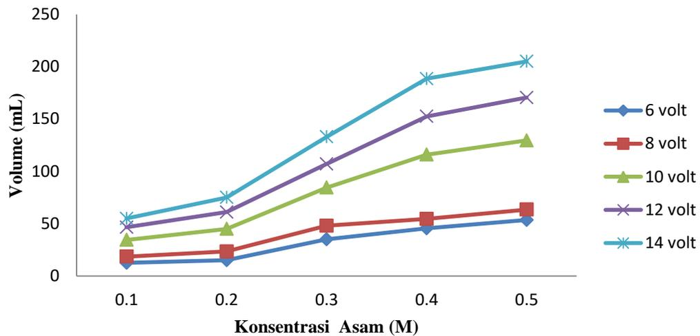
Gambar 4.3 Grafik Pengaruh Konsentrasi  $\text{H}_2\text{SO}_4$  terhadap Volume Gas Hasil Elektrolisis dengan elektroda stainless steel pada Tegangan Bervariasi
