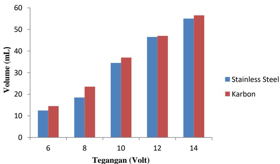
Gambar 4.5 Grafik Pengaruh Elektroda terhadap Volume Gas Hasil Elektrolisis pada Konsentrasi  $\text{H}_2\text{SO}_4$  0,1 M dan Tegangan bervariasi
