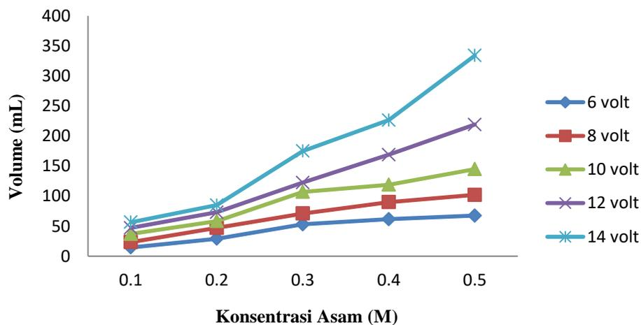
Gambar 4.4 Grafik Pengaruh Konsentrasi  $\text{H}_2\text{SO}_4$  terhadap Volume Gas Hasil Elektrolisis dengan elektroda Karbon pada Tegangan Bervariasi
