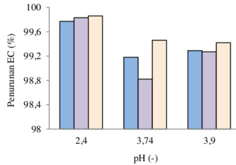
Gambar 3. Pengaruh pH air asam tambang sintetik terhadap persentase penurunan EC permeat pada unit RO (■ = 0,25 L/menit, □ = 0,5 L/menit, ■ = 1 L/menit).
