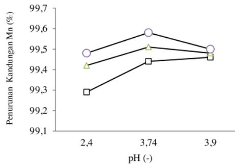
Gambar 6. Pengaruh pH air asam tambang sintetik terhadap persentase penurunan kandungan mangan pada unit RO (□ = 0,25 L/menit, Δ = 0,5 L/menit, ○ = 1 L/menit).
