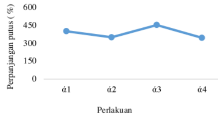
Gambar 4. Perpanjangan putus ( Elongation at break ) % kompon karet dengan menggunakan ekstraksi kayu secang
