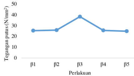
Gambar 8. Tegangan putus ( Tensile strength ) N/mm 2 , kompon karet setelah pengusangan dengan menggunakan campuran silika dari pasir kuarsa dan CaCO 3 dari kulit kerang
