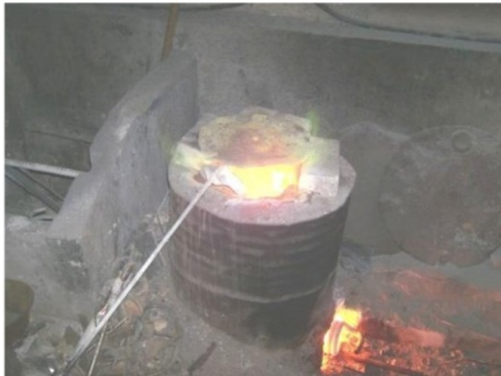
Gambar 1.12 Tungku pengecoran menggunakan bahan bakar solar
