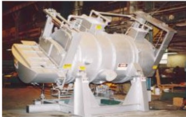
Gambar 1.11. Tungku pengecoran dengan menggunakan sumber energi listrik
