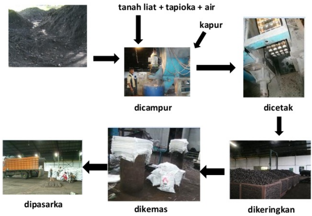
Gambar 1.4 Diagram alir pembuatan briket non karbonisasi
