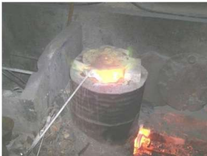
Gambar 1.12 Tungku pengecoran menggunakan bahan bakar solar
