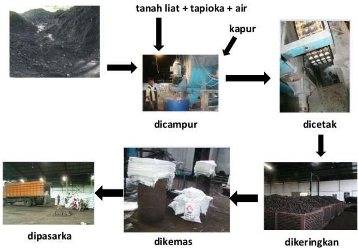
Gambar 1.4 Diagram alir pembuatan briket non karbonisasi
