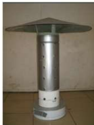
Gambar 1.7 Alat penghangat anak ayam menggunakan briket
