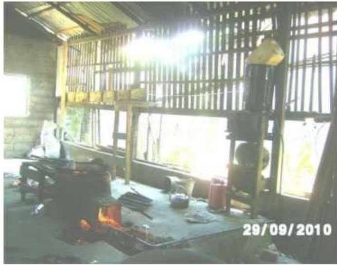
Gambar 1.13 Tungku pengecoran berbahan bakar minyak tanah
