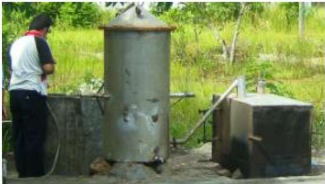
Gambar 1.9 Penyulingan minyak atsiri
