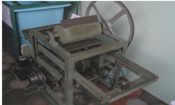
Gambar 12. Alat penyerut daun nenas tipe silinder setelah dimodifikasi
