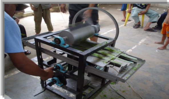
Gambar 11. Alat penyerut daun Nenas sebelum dimodifikasi
