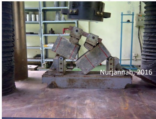
Kondisi balok di akhir pengujian
