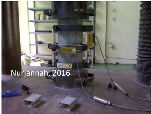
Set up Pengujian Modulus Elastisitas Statik
