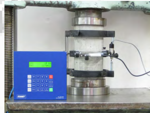
Set up Pengujian Modulus Elastisitas Statik dan Poisson's Ratio .
