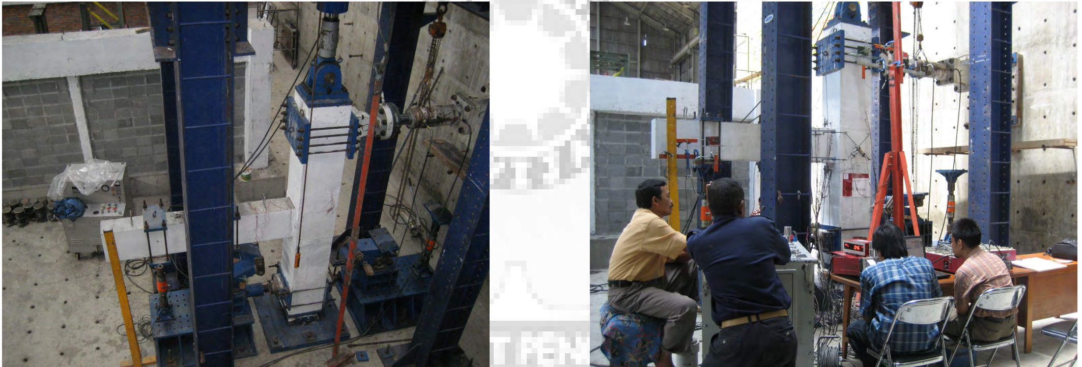
Set up pengujian sub-assembly balok kolom eksterior
