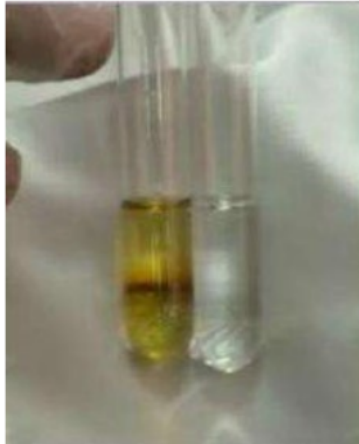
Gambar 9. Positif Uji Hopkins-Cole (Kiri positif, Kanan Negatif) (Positif ada cincin berwarna coklat)
