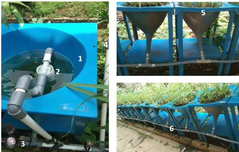
Gambar 9 Prototype sistem irigasi evapotranspiratif bawah permukaan
