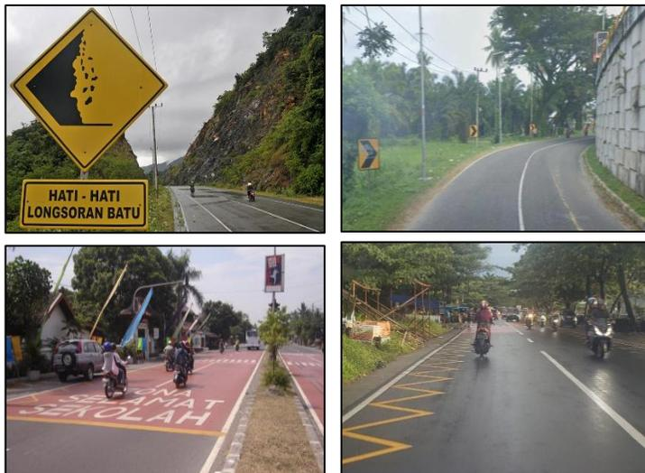
**Gambar 38.** Contoh perlengkapan jalan (markah dan rambu)
