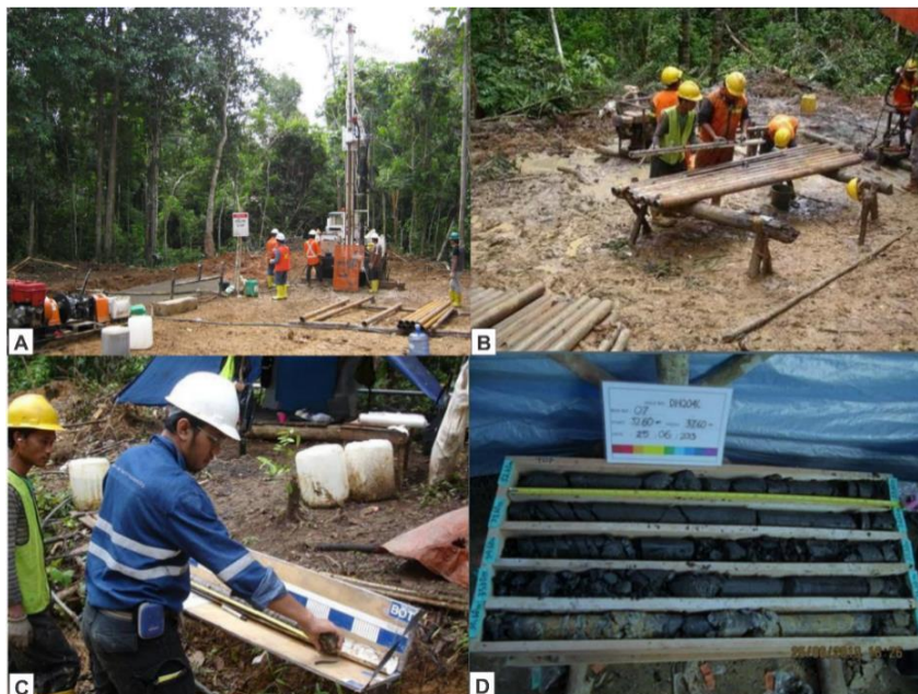
Gambar 4.2 (a) Kegiatan pemboran dengan sudut vertical ; (b) Panjang dan pencatatan inti pemeriksaan yang diterima oleh ahli geologi di lokasi; (c) Memeriksa panjang dan pencatatan inti yang dipulihkan oleh geologist di lokasi; (d) Pengambilan bukti hasil pemboran pada kotak penyimpanan.
