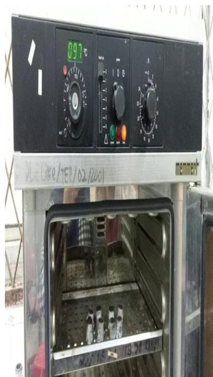
Pengeringan sampel tanah menggunakan oven dengan
