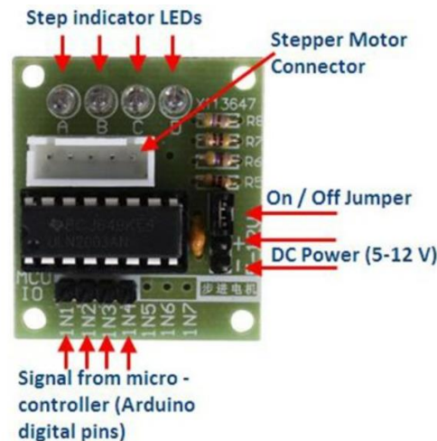
Gambar 3.14 Komponen pada modul motor driver
