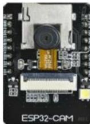
Gambar 2.5 Modul Mikrokontroler ESP32-CAM (Isrofi dkk., 2021)
