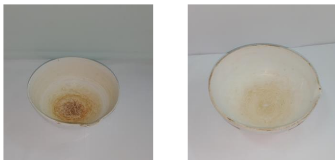
Gambar 26. Hasil Uji TDS ( Total Dissolved Solid ) Sebelum dan Setelah Proses Elektrokoagulasi
