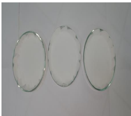
Gambar 28. Hasil Kontrol Uji TSS Limbah Cair Usaha Laundry Sebelum Proses Elektrokoagulasi
