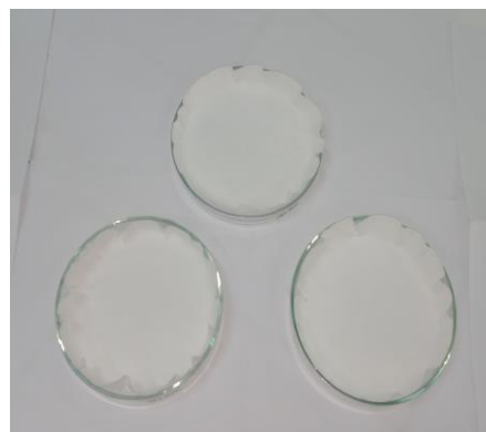
Gambar 29. Hasil Kontrol Uji TSS Limbah Cair Usaha Laundry Setelah Proses Elektrokoagulasi
