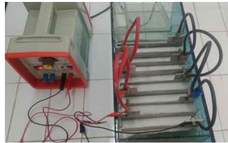
Gambar 13. Proses Elektrokoagulasi dengan Naiknya Flok ke permukaan
