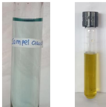
Gambar 24. Hasil Uji COD ( Chemical Oxygen Demand ) Sebelum dan Setelah Proses Elektrokoagulasi
