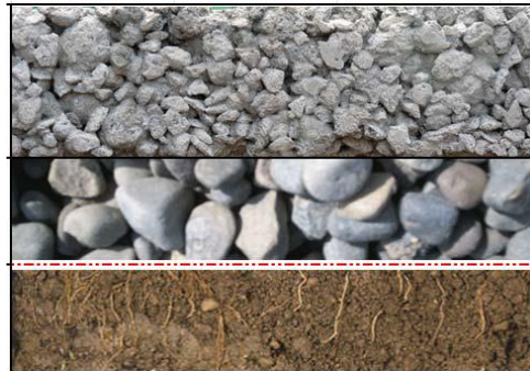
Gambar 2.2. Lapisan Pada Pervious Concrete (Sonebi et al, 2016)
