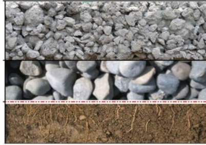
Gambar 2.2. Lapisan Pada Pervious Concrete (Sonebi et al, 2016)
