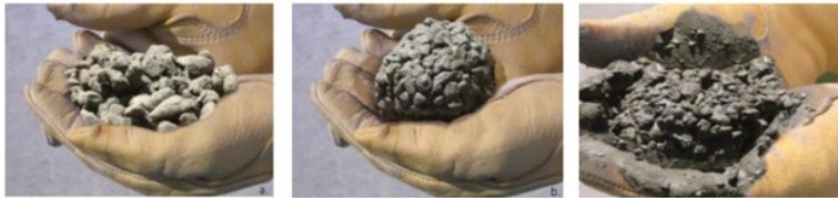
Gambar 2.6. Sampel pervious concrete dengan jumlah air yang berbeda kemudian dibentuk menjadi bola: (a) terlalu sedikit air, (b) jumlah air yang tepat atau optimal, dan (c) terlalu banyak air (Tennis et al. , 2004)
