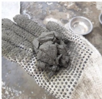
Gambar 3.21. Sampel campuran pervious concrete dibentuk menjadi bola
