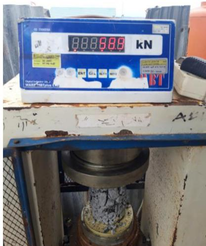
Gambar 3.26. Proses Pengujian Kuat Tekan *Pervious Concrete*
