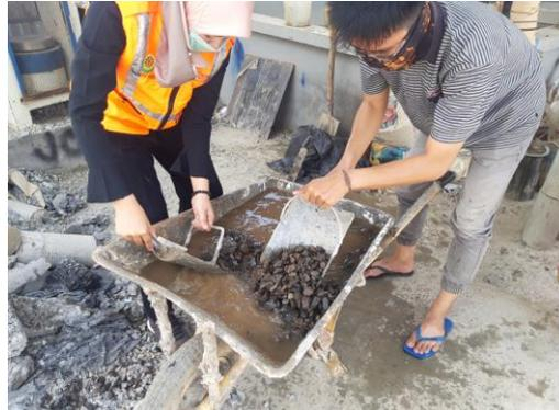
Gambar 3.19. proses pembersihan agregat kasar
