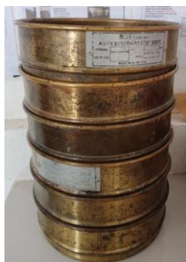
Gambar 3.10. Saringan agregat
