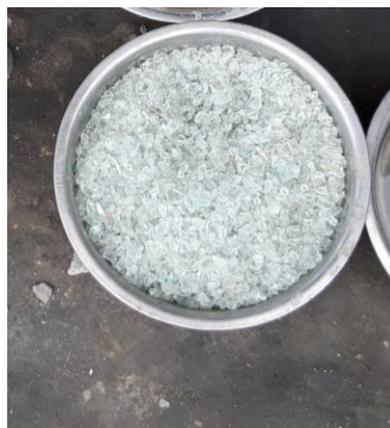
Gambar 3.6. *Waste Glass Aggregate*
