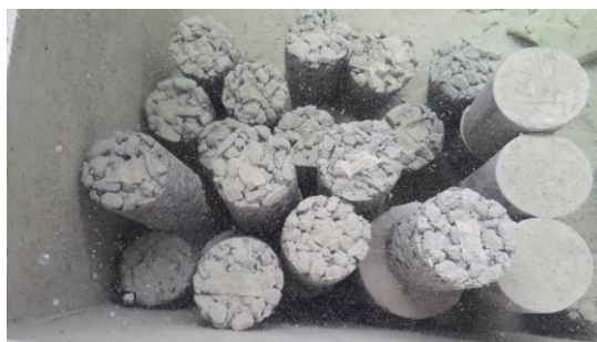
Gambar 3.23. Proses Curing beton dengan direndam di dalam air
