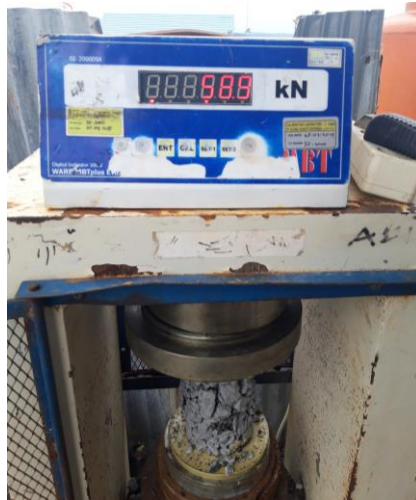
Gambar 3.26. Proses Pengujian Kuat Tekan Pervious Concrete
