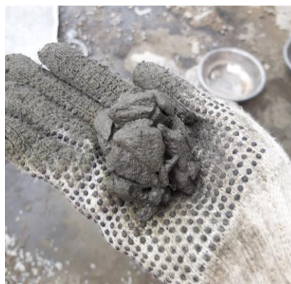
Gambar 3.21. Sampel campuran pervious concrete dibentuk menjadi bola
