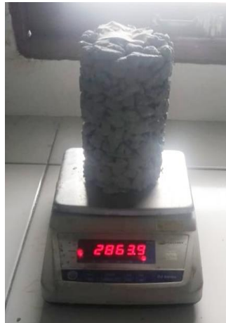
Gambar 3.24. Penimbangan berat benda uji
