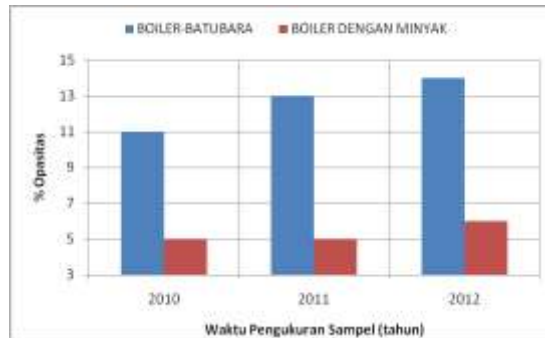
Gambar 6.2. Perbandingan % Opasitas dari Boiler berbahan Bakar Batubara dan Minyak Solar
