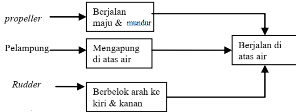
Gambar 6 Bagan Fungsional Sepeda Air
