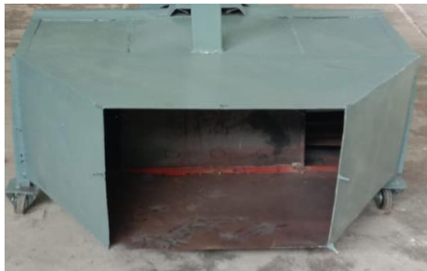
Gambar 5.6. Saluran Outlet Tungku
