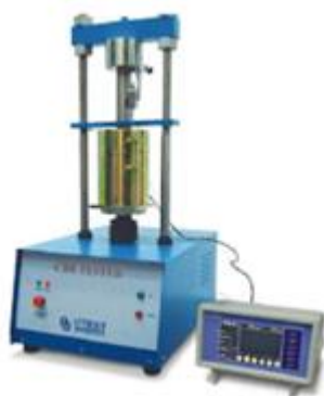
Gambar 2 Alat Uji CBR Laboratorium
