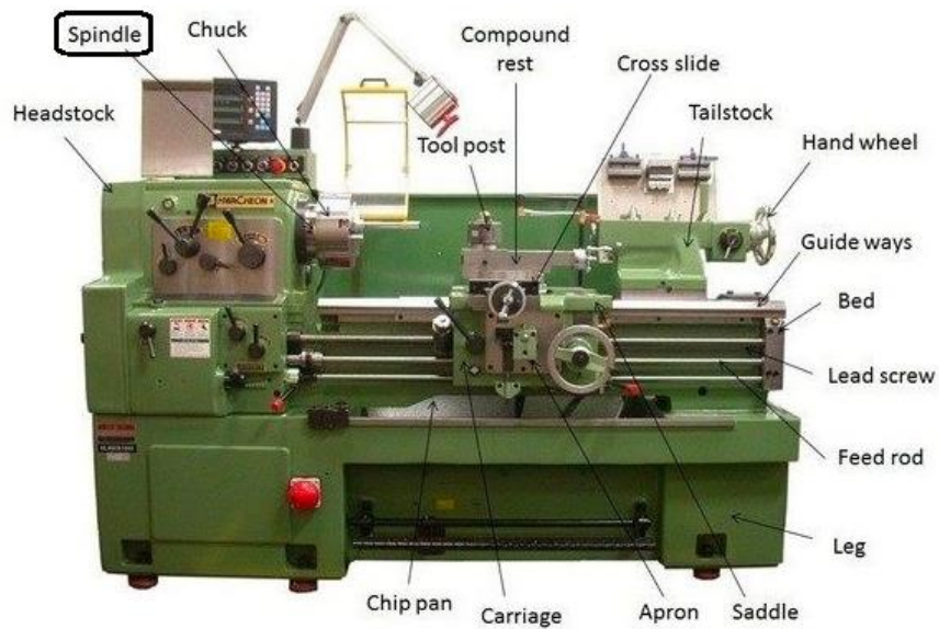
Gambar 2.1. Mesin bubut konvensional ukuran sedang dan komponen utamanya
