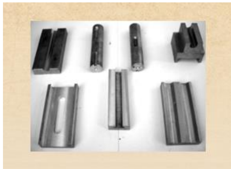
Gambar 4.4 Contoh benda kerja yang dapat dibuat di mesin bubut menggunakan alat bantu yang diterapkan
