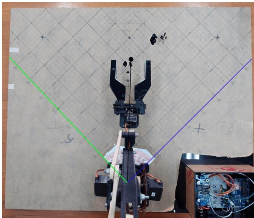
Gambar 4.8 Pengukuran titik koordinat x,y
