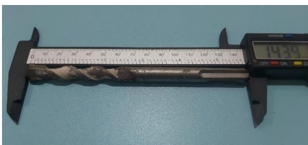
Gambar 4.22 Kondisi Bit sebelum digunakan sampel 3 kecepatan 1238 berat 114 N
