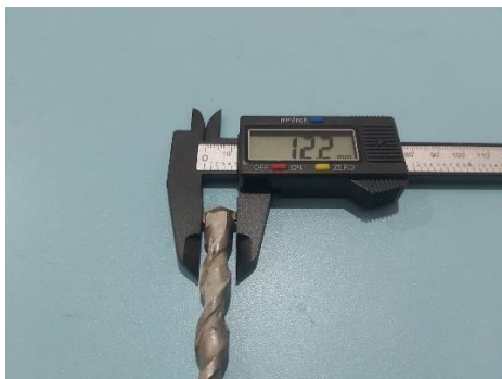
Gambar 4.18 Kondisi Bit sebelum digunakan sampel 3 kecepatan 1260 berat 69 N
