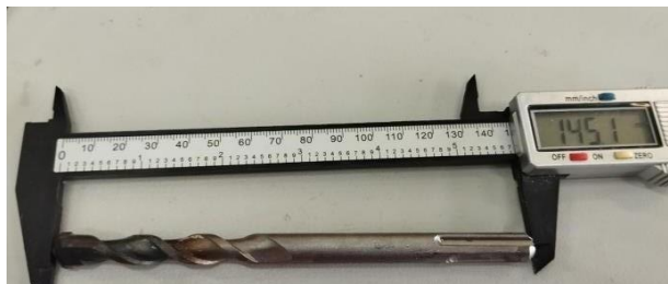
Gambar 4.6 Kondisi bit setelah digunakan sampel 1 kecepatan 1228 rpm berat 69 N
