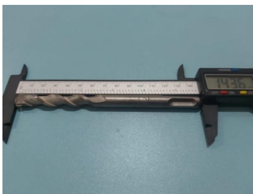
Gambar 4.14 Kondisi Bit setelah digunakan sampel 2 kecepatan 1231 berat 91
