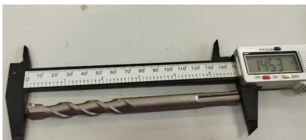
Gambar 4.5 Kondisi Bit sebelum digunakan sampel 1 kecepatan 1270 rpm berat 69 N
