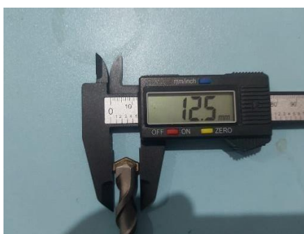
Gambar 4.17 Kondisi Bit sebelum digunakan sampel 3 kecepatan 1270 rpm berat 69 N
