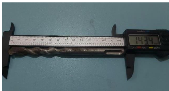
Gambar 4.20 Kondisi Bit sebelum digunakan sampel 3 kecepatan 1239 rpm berat 91 N
