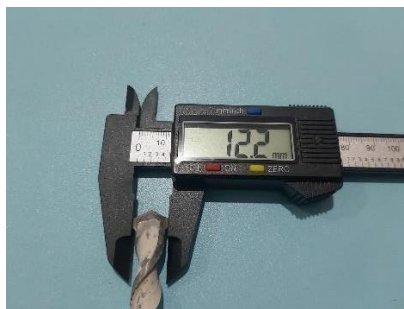
Gambar 4.16 Kondisi Bit sebelum digunakan sampel 2 kecepatan 1209 rpm berat 114 N
