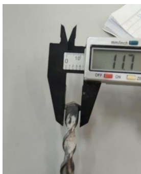
Gambar 4.8 Kondisi Bit setelah digunakan sampel 1 kecepatan 1223 rpm pembebanan 91 N
