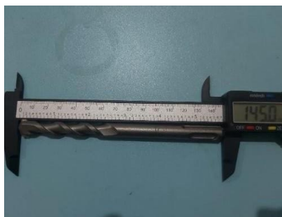
Gambar 4.13 Kondisi Bit sebelum digunakan sampel 2 kecepatan 1270 berat 91 N
