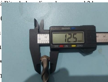
Gambar 4.15 Kondisi Mata Bor Sebelum Uji Pengeboran dengan beban 114 N dan kecepatan 1270 rpm
