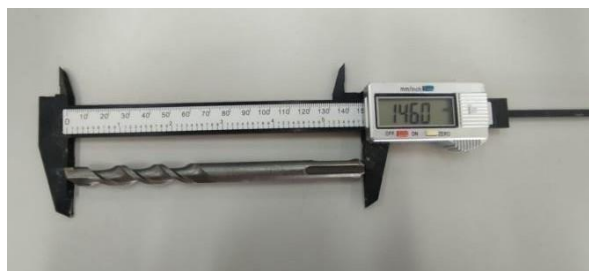
Gambar 4.11 Kondisi Bit sebelum digunakan sampel 2 kecepatan 3 berat 69 N
