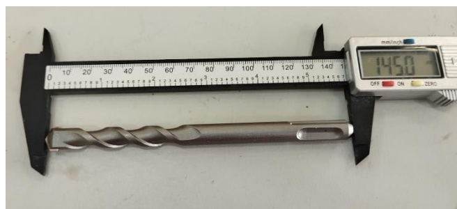
Gambar 4.9 Kondisi Bit sebelum digunakan sampel 1 kecepatan 1270 rpm berat 114 N
