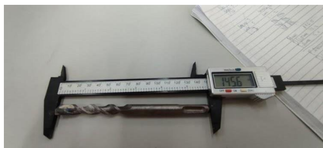
Gambar 4.12 Kondisi Bit setelah digunakan sampel 2 kecepatan 3 berat 69 N
