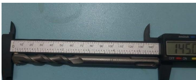
Gambar 4.21 Kondisi Bit sebelum digunakan sampel 3 kecepatan 1270 berat 114 N
