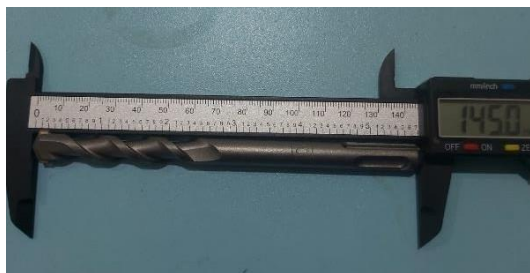
Gambar 4.19 Kondisi Bit sebelum digunakan sampel 3 kecepatan 1270 berat 91 N
