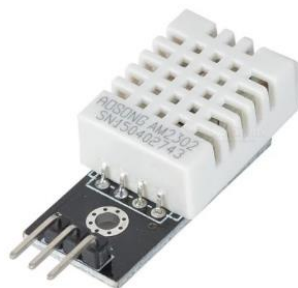
Gambar 2. 4 Sensor Suhu dan kelembapan DHT22
