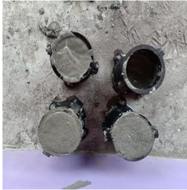
Gambar 3.26. Pencetakan benda uji silinder
