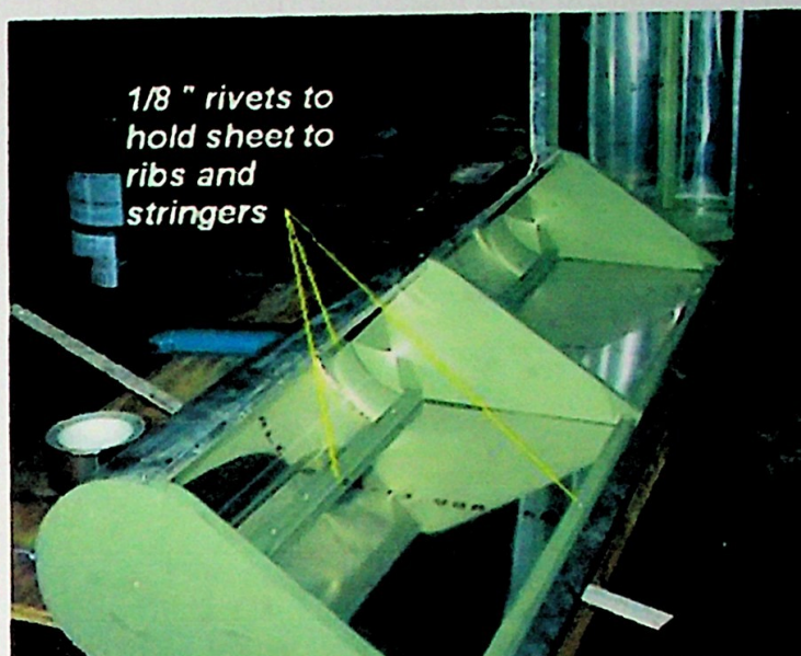
(c) Konstruksi Sudu yang telah jadi
