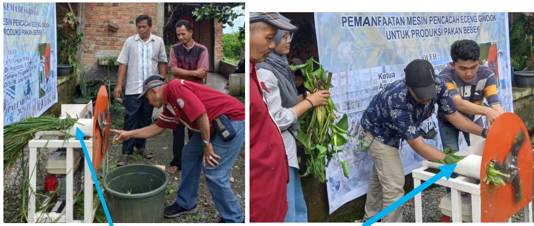
Gambar 3. Lubang pengumpan bahan ke pisau
