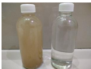
Gambar 4. Air sebelum dan setelah filtrasi
