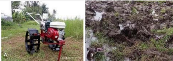
**Gambar 9.4:** (A). Hasil produk traktor rakitan dengan mesin motor bekas, dan (B). hasil kinerja alat traktor pada lahan (Refindo, 2023)
