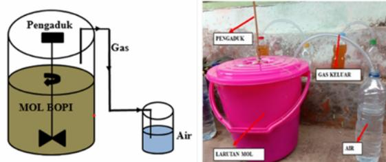
**Gambar 9.1:** Rangkaian alat pembuatan MOL (Broto et al., 2019)
