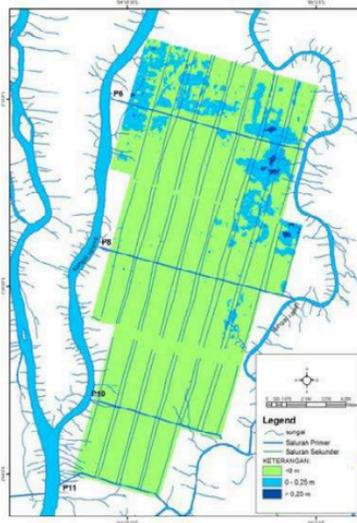
Gambar 12. Kondisi muka air setelah retensi air dan panen hujan
