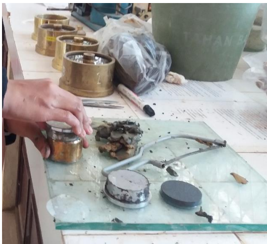
Pembuatan sampel konsolidasi
