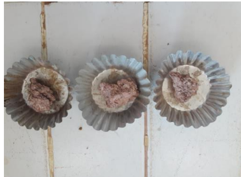
Hasil pengujian batas cair
