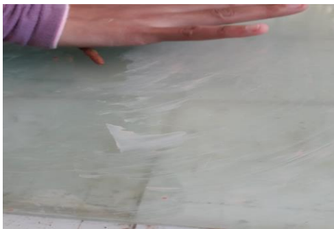
Pembuatan sampel batas plastis
