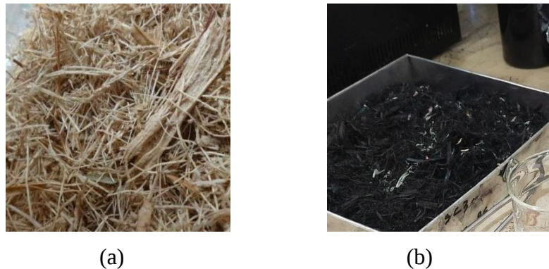
Gambar 4. 1. (a) Ampas tebu kering; (b) Karbonisasi ampas tebu
