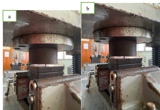
Gambar 11. (a) sampel di uji kekuatan tekan menggunakan alat Universal testing mechine , (b) sampel di uji kekuatan tekan menggunakan alat Universal testing mechine
