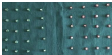
Gambar 2. Bahan dalam cetakan stainless yang berbentuk tabung dengan ukuran 4x6 mm 8
