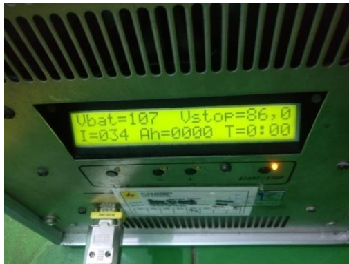
Gambar 4.1 Setting Pengosongan Baterai 110 VDC Bank 1 Gardu Induk Sungai Kedukan Palembang.
