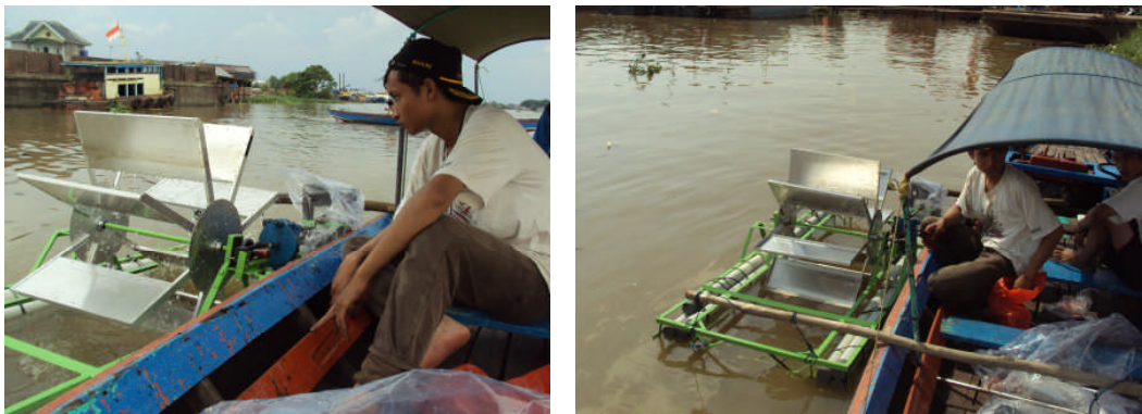
Gambar 58. Pengujian dengan simulasi kecepatan aliran pada anak Sungai Musi.
