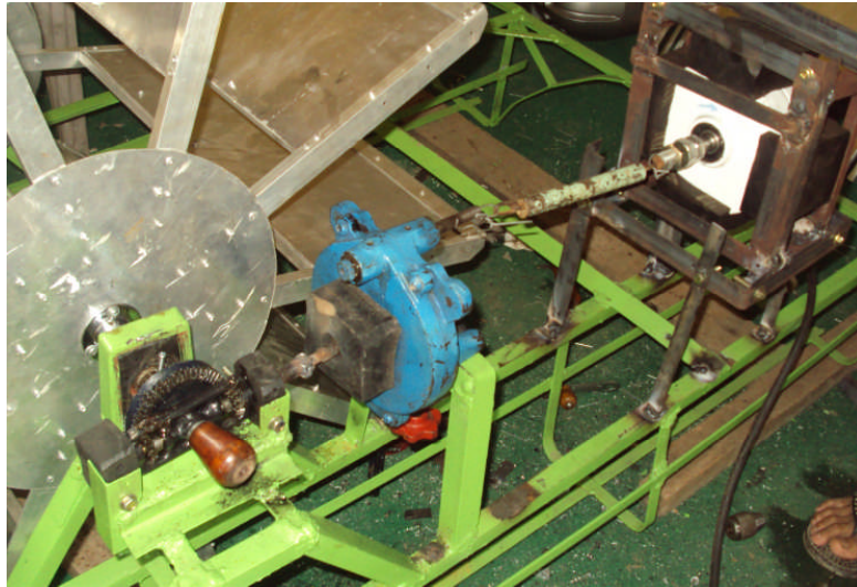
Gambar 55. Sistem transmisi roda gigi dan kopling ke alternator.
