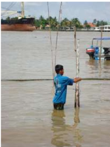
Gambar 4.13. Grafik Pasut dan Teknik Pengamatan dan Pengikatan Ke titik Tinggi
