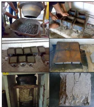
**Gambar 3.** Pembuatan, perawatan dan pengujian benda uji
