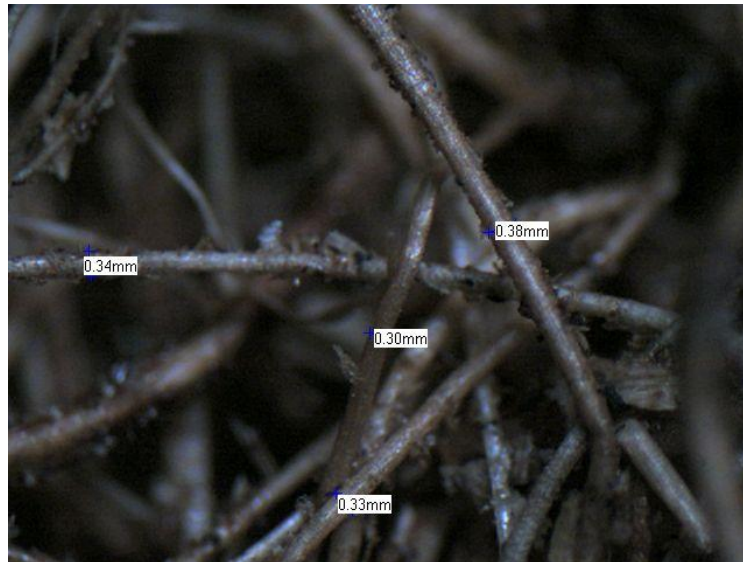
Gambar 3 Foto sampel serat sabut kelapa dibawah mikroskop dengan pembesaran 50X
